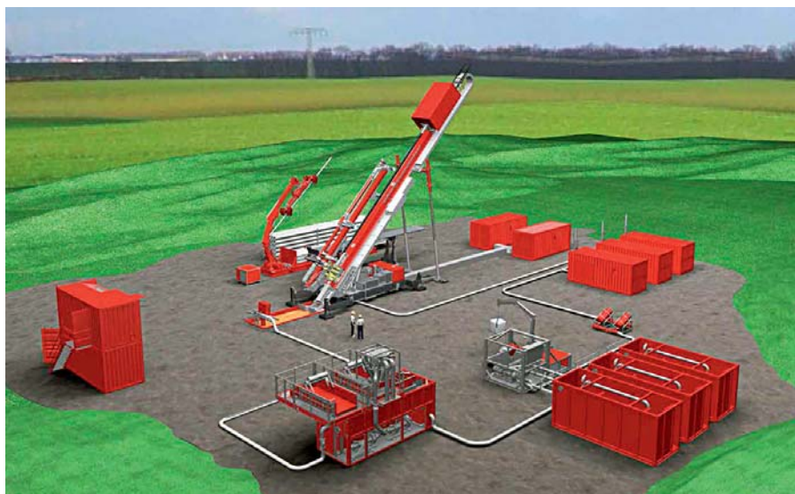
Пример компоновки многофункциональной наклонной буровой установки (МНБУ)
