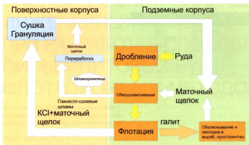
Рис. 2. Принципиальная схема подземной обогатительной фабрики
