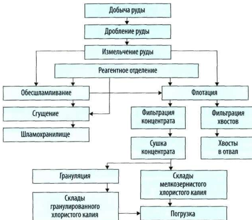
Рис. 1. Схема производства хлористого калия флотационным способом.
