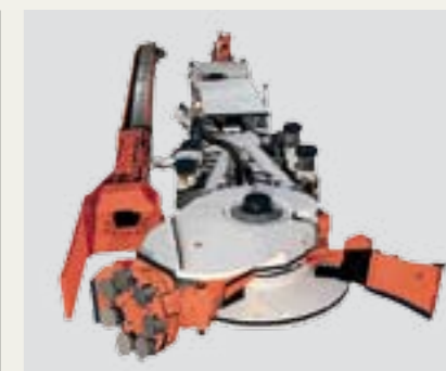
Комбайн MN 220 Reef Miner для рудных тел малой мощности
