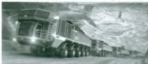
Автопоезд из самосвалов ETF Боковая разгрузка автопоезда самосвалов ETF
